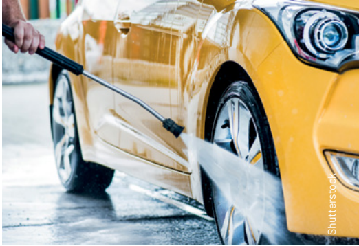
Painepesuri noin 100–150 bar.
