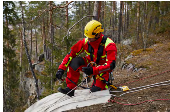
Kuva 83. Nousukahvan ja jalkalenkin kiinnittäminen reunanylitystä varten.
