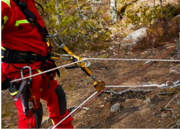
Kuva 78. Työ- ja varmistusköysi.
