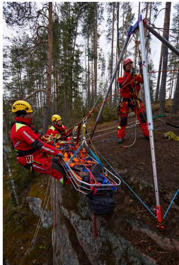
Kuva 130. Multipodi osana köysipelastusjärjestelmää.
