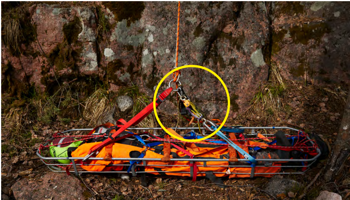
Kuva 128. Koripaarin asennon muutoksen mahdollistava säätömekanismi (pelastustalja).
