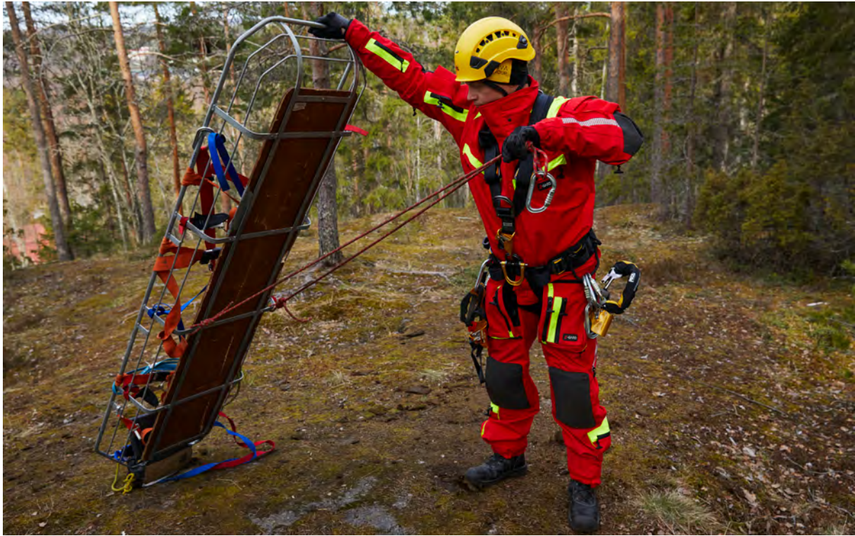
Kuva 129. Koripaariin kiinnitetty Y-nostoliina/-köysi.
