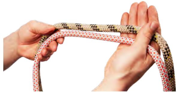
Kuva 21. Erivahvuisia köysiä käytettäessä tarkasta väli- neiden yhteensopivuus (11 mm ja 1,5 mm)
