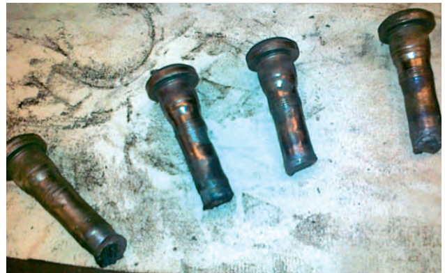
Kuva 3. Vanteen pultit ovat vaurioituneet pahoin kun ajon aikana pultit ovat olleet löysällä.
