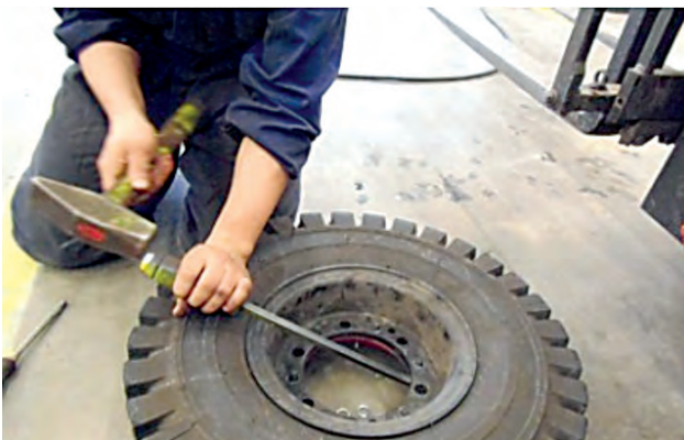
5. Irrota vanteen osat erilleen siiben soveltuvalla työkalulla.
