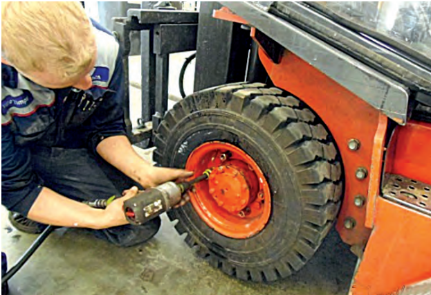
15. Kiinnitä varsinaiset pyöränpultit.
