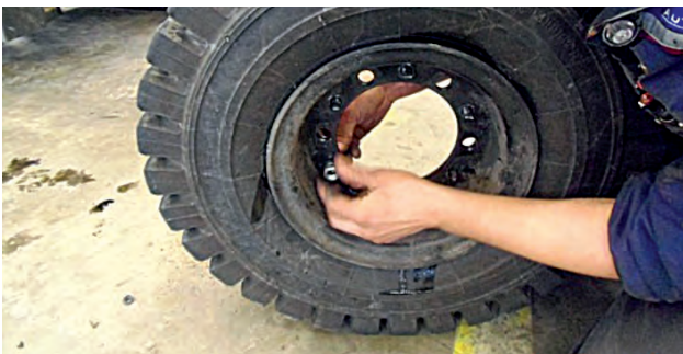
11. Asenna toinen vanteen puolisko renkaaseen.
