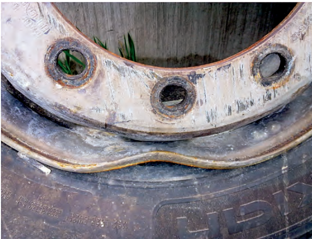
Ajon aikana vaurioitunut vanteen reuna, mikä johtaa vanteen hylkäämiseen.
