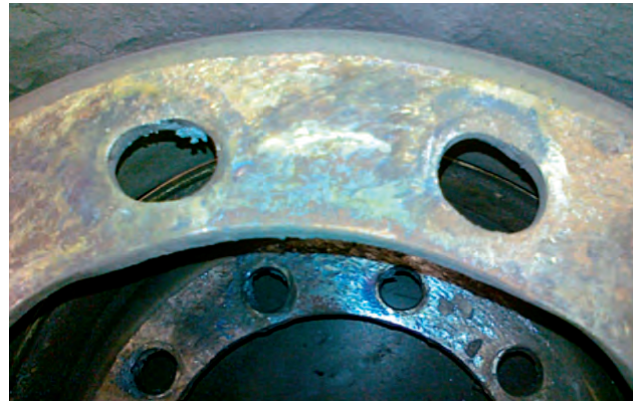
Kuva 2. Vantaan pulttien reiät ovat tulleet soikeanmuotoisiksi kun ajon aikana pultit ovat olleet löysällä.
