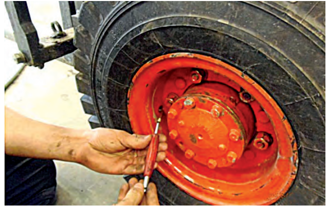
2. Poista renkaasta venttiilineula. Huom. Rengasta ei saa koskaan irrottaa paineellisena.
