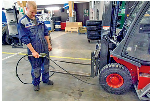
16. Täytä rengas vasta tässä vaiheessa täyttöpaineeseen vähintään 2 m päässä ja seisomalla renkaan kulutuspuolelta.
