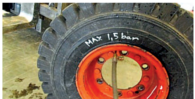
14. Laita renkaaseen hieman ilma, maksimissaan 1,5 bar.
