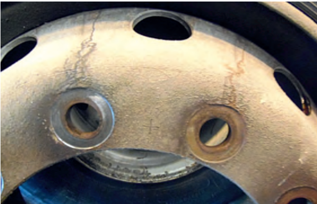
Kuva 1. Kun vanteen pultit ovat olleet löysällä ajon aikana, on vanteeseen jäänyt sadekelillä kuvan mukaiset pulttien juurista lähtevät valumisraidat. Toinen merkki pyörän muttereiden löysyydestä on laippamutterin ja vanteen yhtymäkohtaan ajon aikana tullut obut ja kirkas biertymäjälki.
