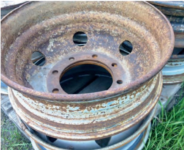
Tyypillinen kauttaaltaan ruostunut kuorma-auton vanne, joka tulisi kunnostaa tai romuttaa.
