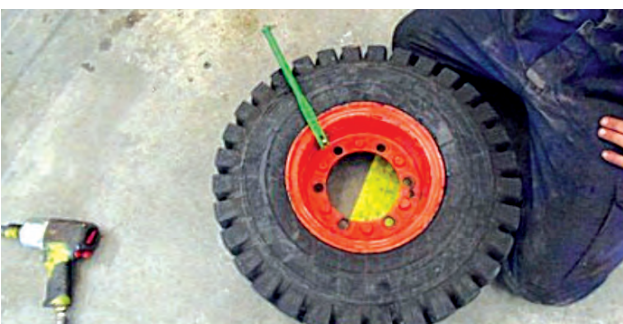
13. Laita uusi neula ja lukitse se paikalleen.
