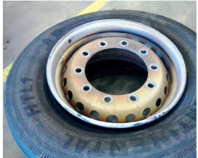
Ylikuumentunut vanne kun pyörän laakeri on hirttänyt kiinni johtaa hylkäämiseen. Vanteen laipassa on havaittavissa selvä värimuutos.
