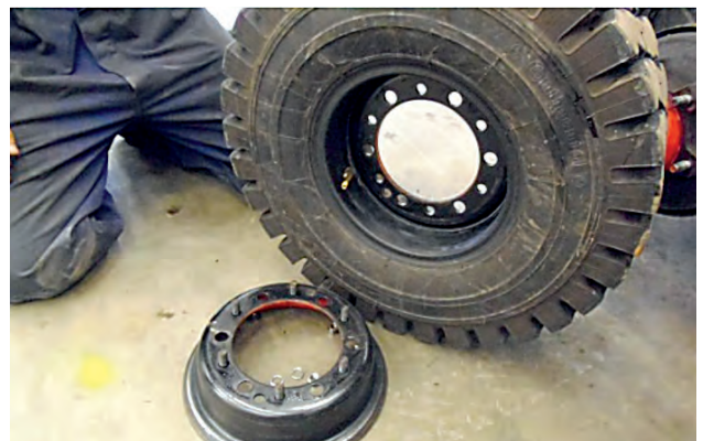
6. Toinen vanteen osista on nyt irrotettu.
