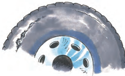
Huonokuntoinen rengas, joka ilmeisesti on ajettu tyhjänä (kylkivaurioita).
