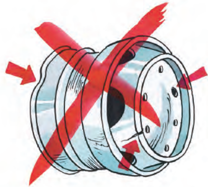
Huonokuntoinen vanne, joka on romutettava.
